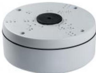
Монтажная коробка для видеокамеры Optimus предназначена для выполнения монтажа видеокамер OPTIMUS серии IP-P Starvis на вертикальной или горизонтальной поверхности внутри помещений или на улице, а также для надежной коммутации подводящих проводов с защитой от механических повреждений и степенью защиты IP66.
